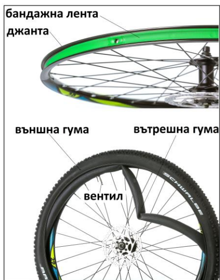
Fig. 35 Banda; llanta; neumático exterior; neumático interior; válvula
